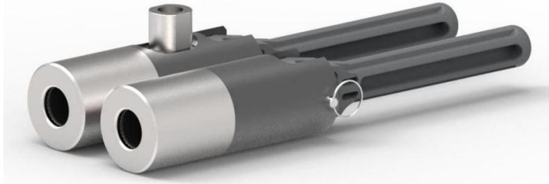
WBM 系列快速连接器，可以实现对直管等测试件的快速密封连接；WBM 系列快速连接器是通过密封圈包裹在测试管件上形成密封，因此在使用过程中必须保证快速连接器密封件和被测工件密封表面干燥，如果密封接触面沾有水等润滑成分的话，其使用压力只能在 1bar 以下。
